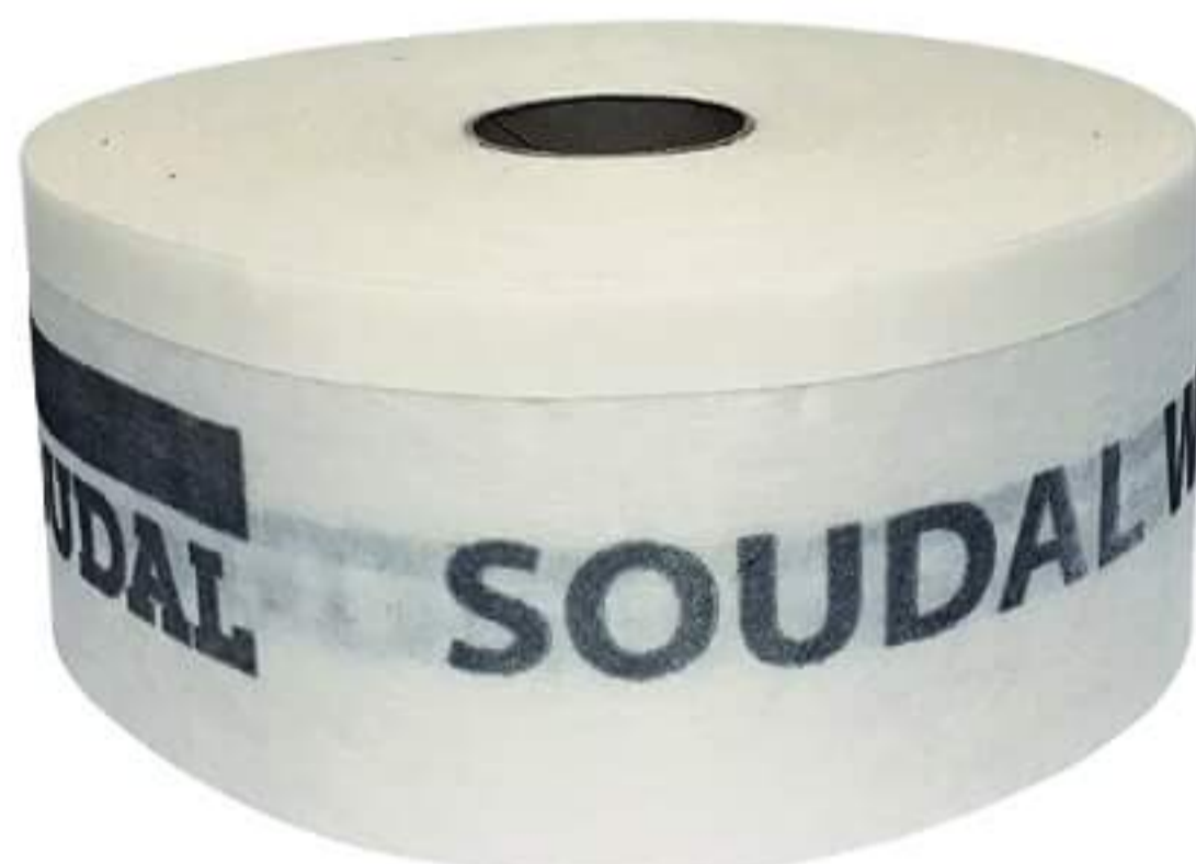
Soudal Window System (SWS). Taśmy paroszczelne chronią piankę przed wodą opadową, a taśmy paroprzepuszczalne – przed wilgocią z wnętrza pomieszczeń, umożliwiając jednocześnie migrację pary wodnej na zewnątrz.
